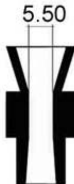
Figura 36: Diametro interno massimo del Venturi
