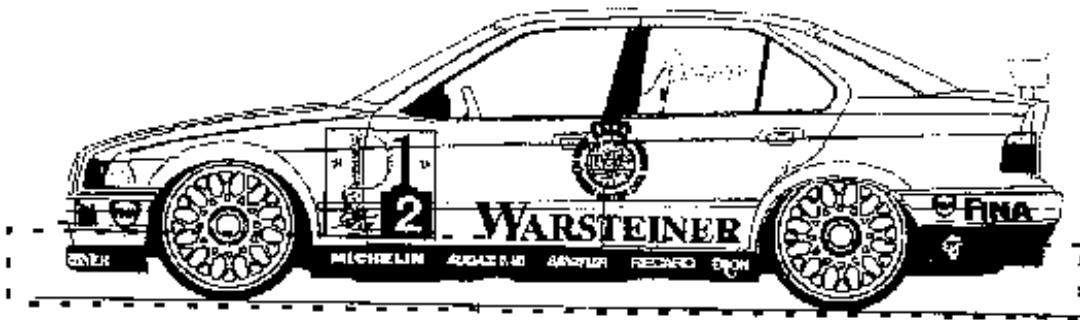
Figura 23: L'area della carrozzeria delimitata dalla linea tratteggiata è la sola a poter essere modificata
